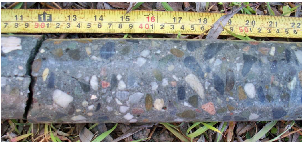
Obr. č. 4 – návrť prasklinou N1 detail
