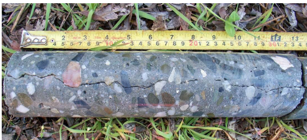
Obr. č. 3 – návrť prasklinou N1 detail
